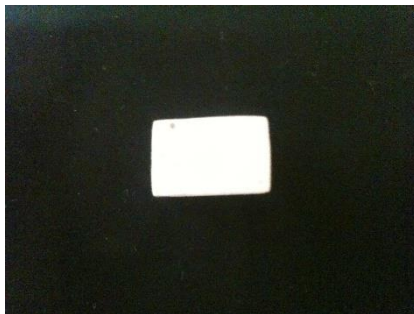
Bloco de gesso, utilizado para confeccionar a matriz. Figura 5
