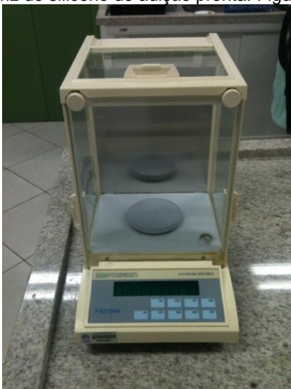
Balança de precisão utilizada para calcular a quantidade de polímero de resina acrílica (PMMA). Figura 8.
