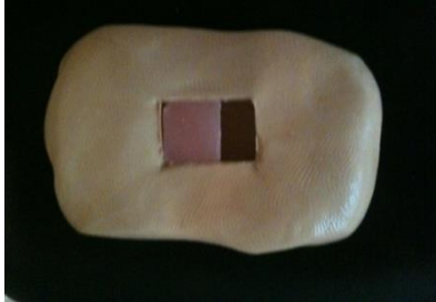
Confeção do modelo piloto. Utilizada resina rosa para efeito de teste, para ver o desempenho da matriz. Figura 9.
