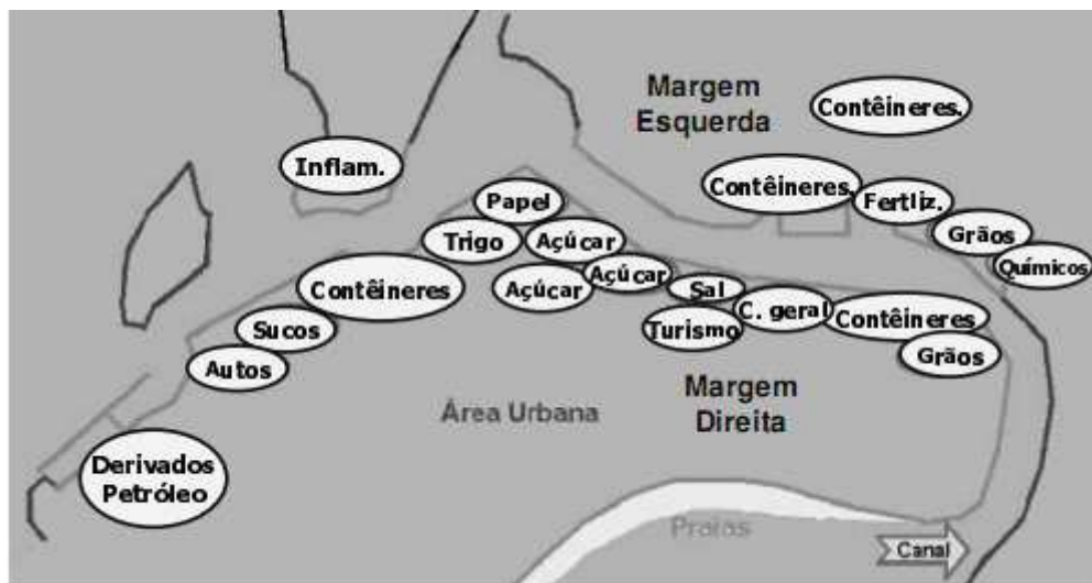
Figura 15: Distribuição dos terminais especializados pelo cais santista Fonte: CODESP (2010)
