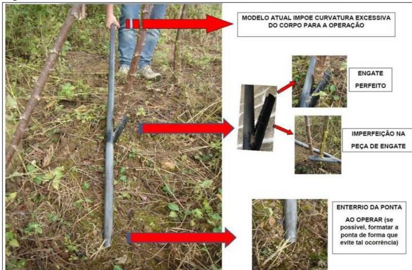
Figura 13 - Detalhamento do extrator manual de mandioca.
