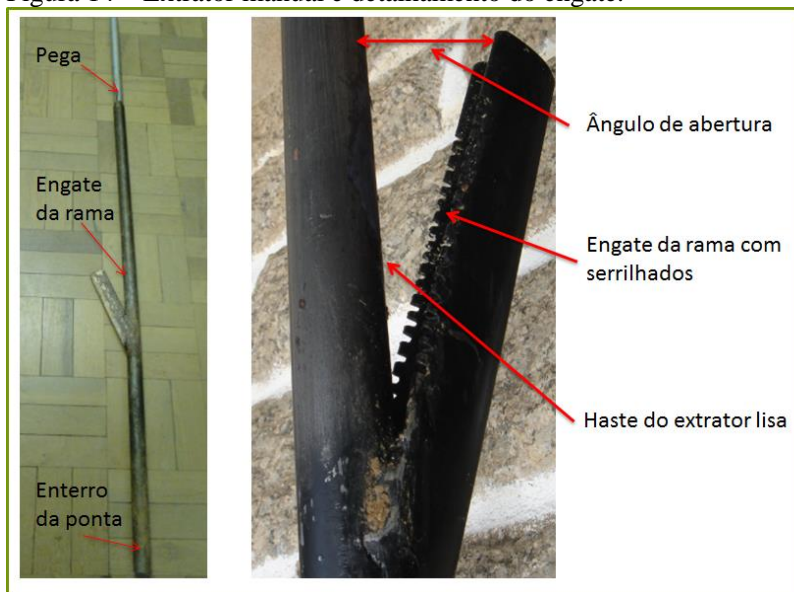
Figura 14 – Extrator manual e detalhamento do engate.
