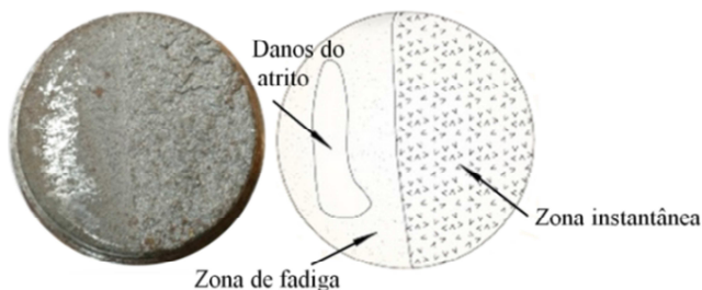
Figura 11 – Fratura por fadiga sem marcas de praia.
