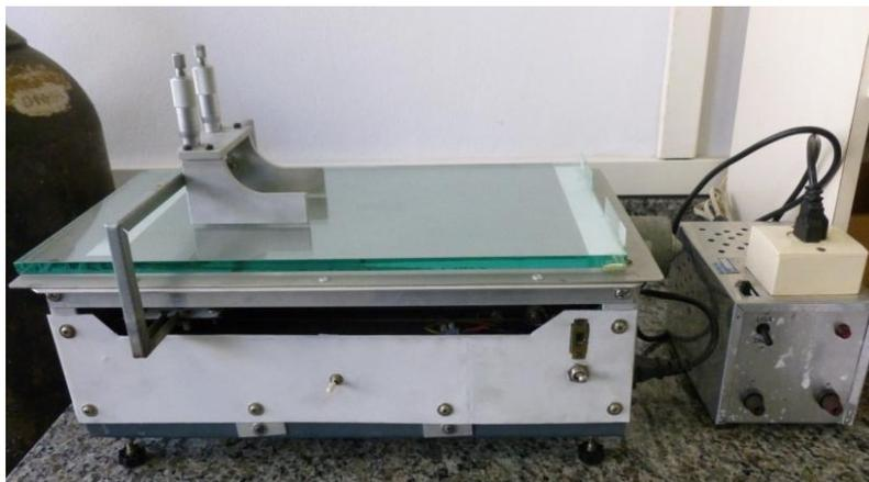
**Figura 76:** Máquina caseira de fabricação de filmes por *casting-shear* com velocidade controlada e constante.
