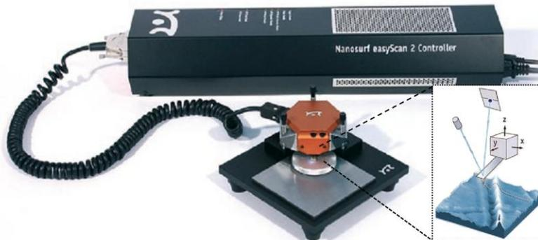
**Figura 17:** Microscópio de força atômica utilizado na caracterização topológica. No detalhe um esquema do funcionamento de medida (interação ponta-superfície e detecção da deflexão devido à reflexão do laser no foto detector). Imagem adaptada do manual da fabricante [49].
