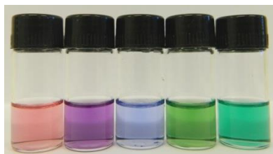
Figura 2. Soluções do composto 2 em metanol, etanol, 1-octanol, DMA e diclorometano.
