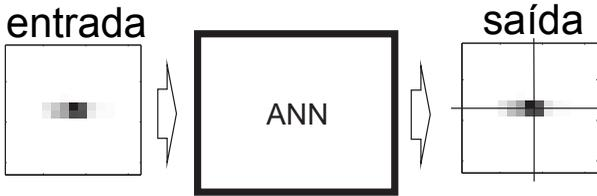
Figura 32 – Diagrama da ANN para determinação de centroide. As entradas da ANN são os pixels da imagem de uma subabertura. As saídas são as posições  $x$  e  $y$  do centro real. Para treinar a ANN as saídas são fornecidas com as entradas; quando em uso, a ANN deve gerar as saídas corretas automaticamente.
