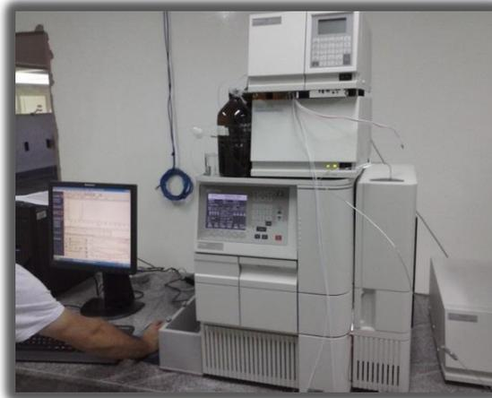
**Figura 9.** Detector de fluorescência Waters 2475 acoplado a cromatógrafo líquido de alta eficiência Waters modelo Alliance e2695 na Embrapa Semiárido, Petrolina PE – Brasil. Fonte: Próprio autor.
