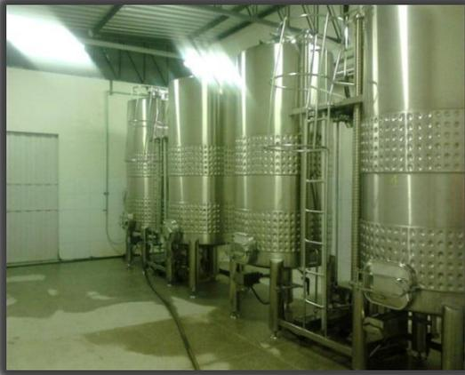
**Figura 4.** Tanque pulmão para armazenagem do suco na ASA Ind. e Com. Ltda, Petrolina PE – Brasil. Fonte: Próprio autor.
