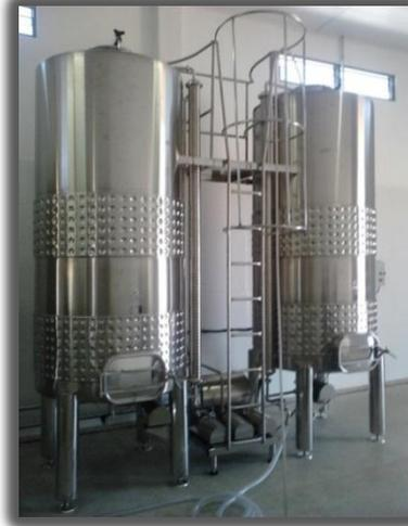
**Figura 4.** Esquema da maceração com remontagem constante e separação do suco da uva por drenagem. Fonte: Próprio autor.
