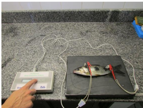
Fig. 3 – Leitura de Bioimpedância sendo realizada durante experimento.
