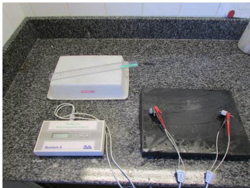
Fig. 1 – Equipamento Quantum X Tetrapolar Bioelectrical Impedance Analyzer, superfície não condutora e conjuntos de agulhas intradérmicas.
