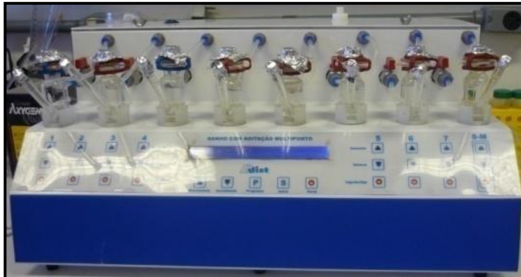
Figura 10- Modelo da câmara de difusão de Franz.
