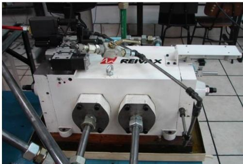
Figura 3.2 – Válvula distribuidora VD TN70. (REIVAX, 2013).
