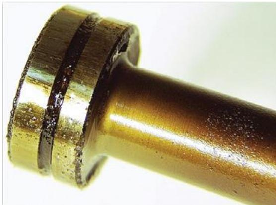
Figura 2.31 – Travamento hidráulico por obstrução dos entalhes dos ressaltos do carretel. (Adaptado de EPT, 2013).
