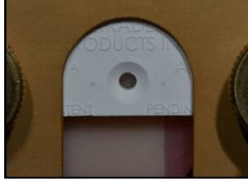
Fig 5- Molde de teflon (Ultradent Jig) com a cerâmica posicionada para confecção dos cilindros de resina composta.
