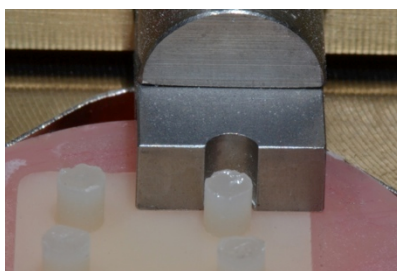
Fig 7- Espécime posicionado para teste de cisalhamento, no equipamento (Shear Bond Tester; Bisco Inc., Schaumburg, IL, EUA).
