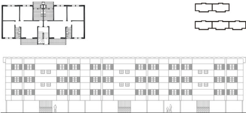
Figura 9 - a) Planta baixa pavimento tipo. b) Distribuição das unidades. c) Fachada do Conjunto Realengo. Fonte: Koury; Bonduki; Manoel (2003).
