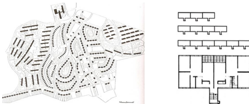
Figura 17 – a) Implantação do conjunto com as casas mais centralizadas situadas junto as vias sinuosas e os edifícios laminares nas extremidades. b) Planta baixa do pavimento tipo. Fonte: Bonduki (2004).
