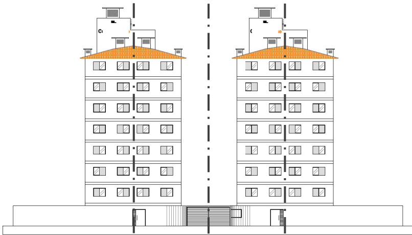
Figura 50 – Princípios de ordem da fachada norte com representação dos eixos de simetria.
