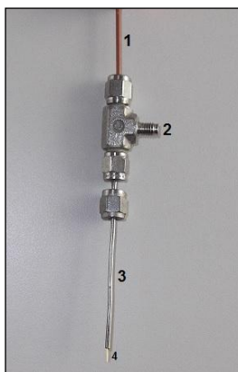
Figura 13 – Sistema montado com: (1) PEEK Tubing anilado com o capilar; (2) Conexão tipo T; (3) Tubo inox por onde escoo o antissolvente; (4) Capilar de sílica fundida por onde escoo a solução orgânica.
