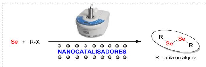
**Figura 3.** Combinação de irradiação de micro-ondas e nanocatalisadores para a síntese de disselenetos orgânicos.
