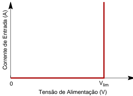
Figura 6: Consumo de corrente do limitador de tensão ideal
