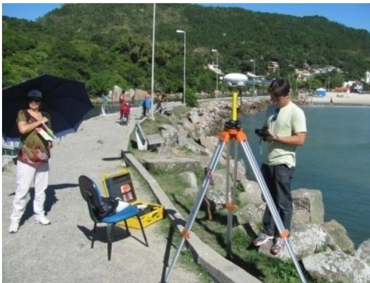
Figura 8. Integrantes da equipe do Laboratório de Oceanografia Costeira - LOC (Carla D'Aquino e Guilherme Vieira) com o GPS-RTK nos molhes da Barra da Lagoa, junto ao referencial de nível CASAN 387. Fotografia: Diego Bitencourt.
