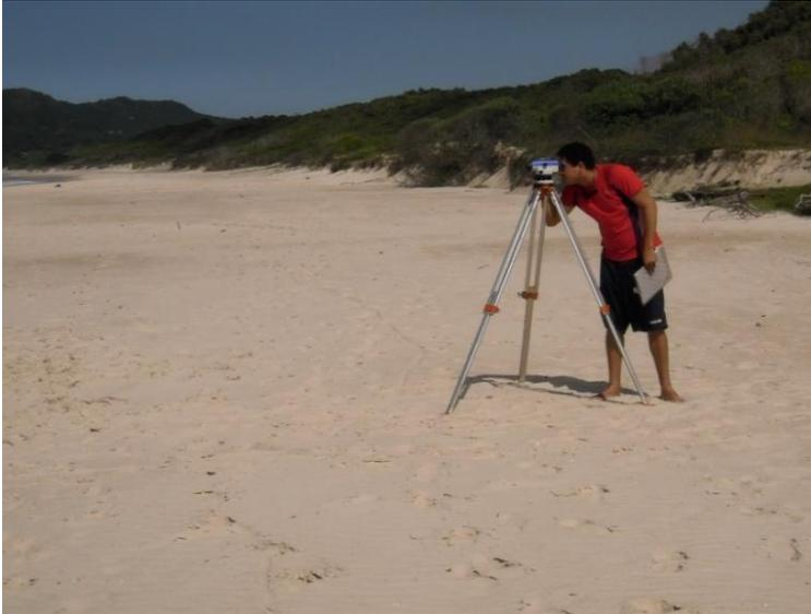
Figura 6. Nível óptico de precisão utilizando no nivelamento geométrico de perfil de praia. Imagem: Alexandre Schweitzer.
