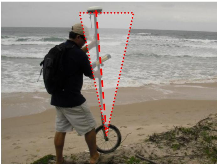
Figura 15. Roda de transporte para a antena móvel do conjunto GPS-RTK, com destaques na imagem para ressaltar a inclinação da antena. Imagem: Jonas Gomes Oliveira. Outubro/2011.
