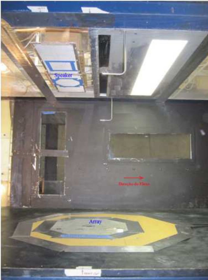
Figura 24 – Montagem experimental mostrando a seção de teste do túnel, speakers , array de microfones e tubos de pitot .
