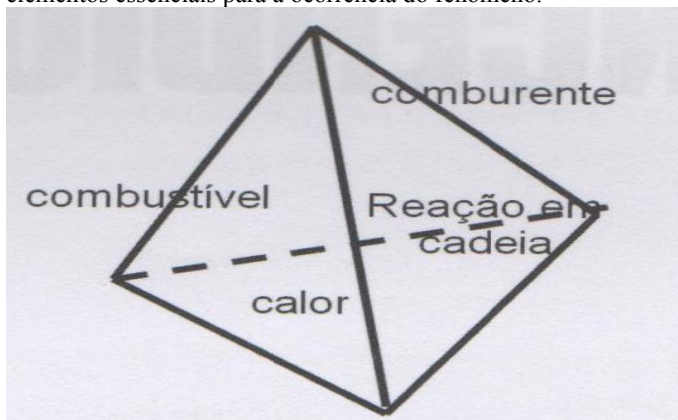
Figura 7 - Esquema representando o “tetraedro do fogo” composto pelos elementos essenciais para a ocorrência do fenômeno.
