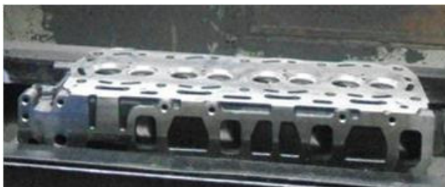
Figura 15 - Cabeçote de motor estudado. Fonte: Empresa (2012).
