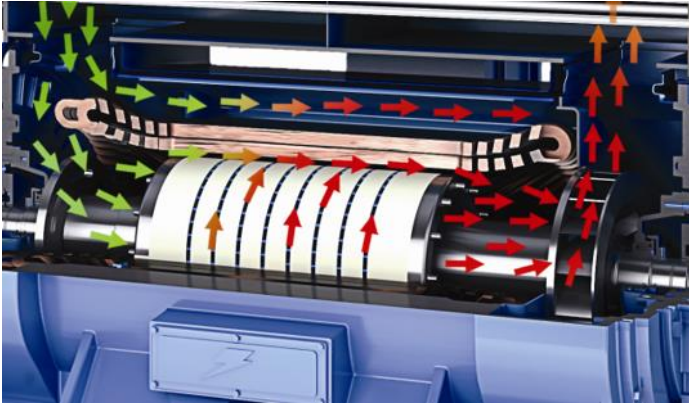
Figura 1-1 – Ilustração de Sistema de Arrefecimento Axial-Radial (Fonte:WEG)
