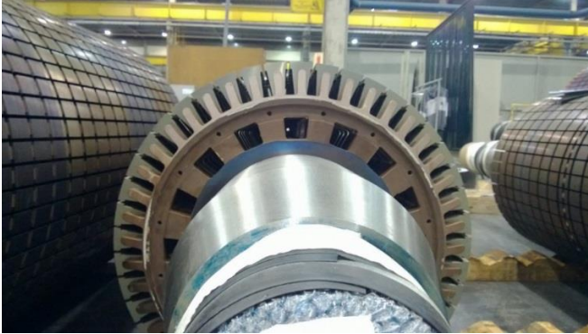
Figura 5-7 – Geometria do Canal Axial Trapezoidal.
