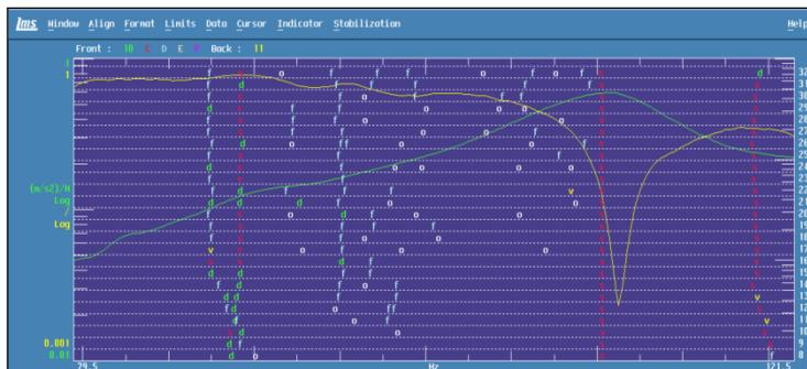
Figura 6.4: Curva de estabilização: 1º modo em 110,2Hz.
