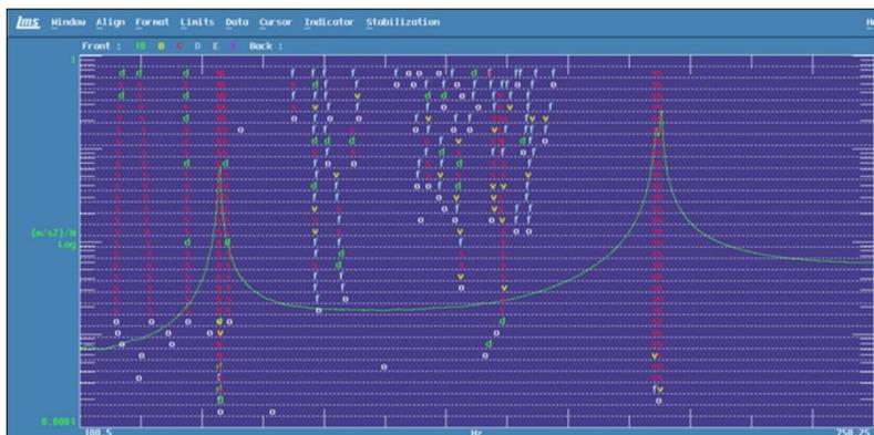
Figura 3.11: Curva de estabilização (livre-livre): primeiro e segundo modos de flexão identificados.
