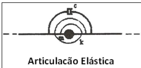
Figura 4.11: Juntas representadas como uma mola e um amortecedor torcional.
