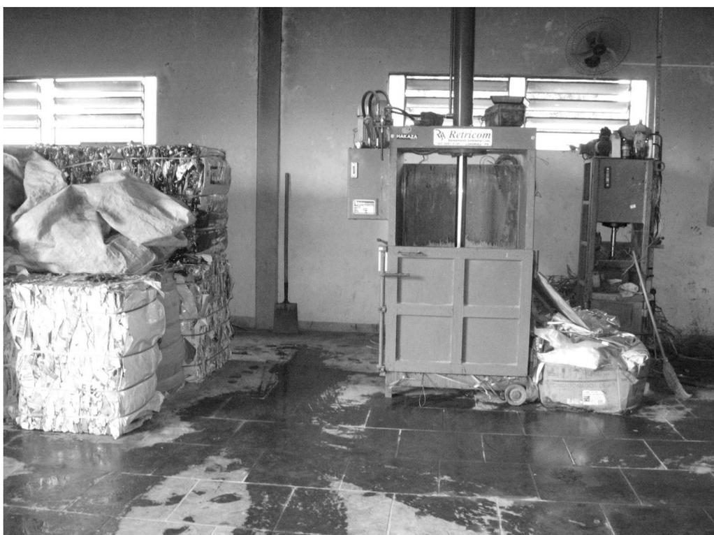
**Ilustração 14: Prensa utilizada para acoplar o material - APRI**
