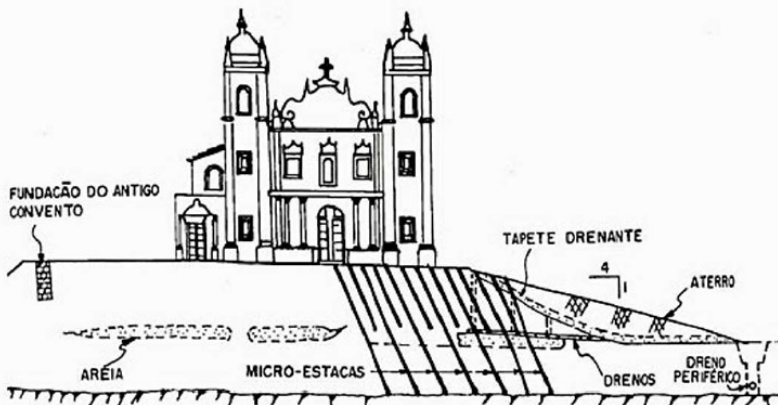
Figura 20 – Corte das obras de reforço da Igreja do Carmo
