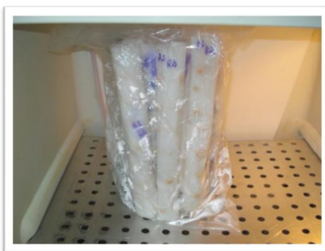
Figura 5: Teste de frio em câmara a 10°C.
