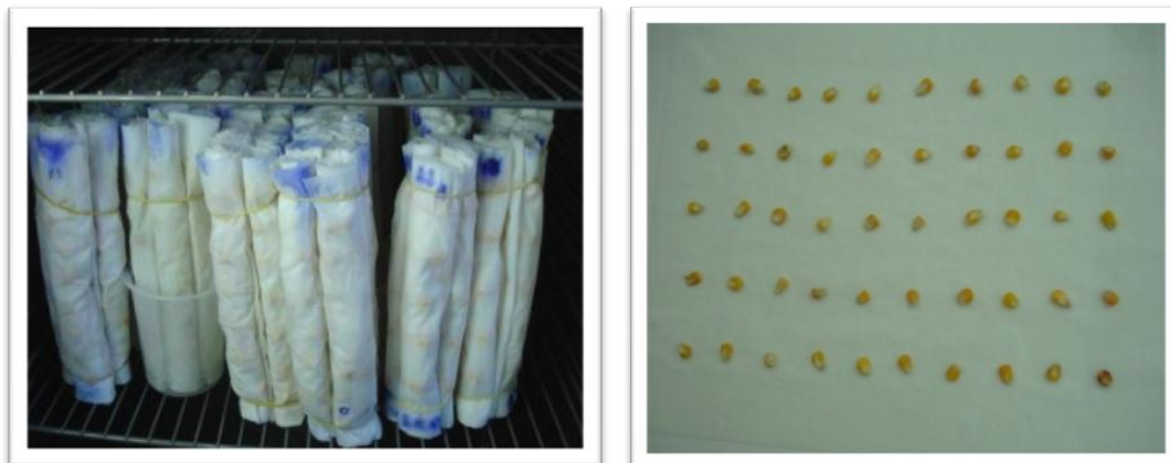
Figura 4: Testes de germinação e vigor em câmara de germinação sob condições de 25°C de temperatura e 100% de umidade em rolo de papel germitest.
