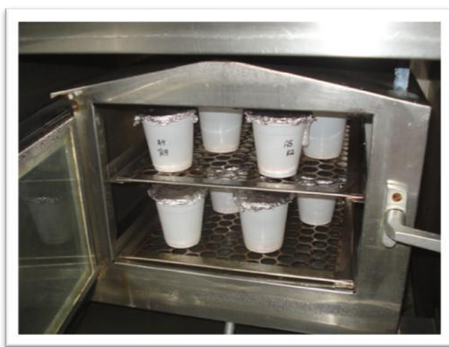
Figura 6: Teste de envelhecimento acelerado em BOD a 42°C e UR 100% por 72 horas
