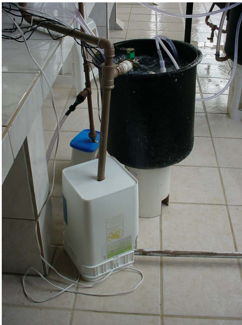
Figura 12: Água para manutenção da temperatura dentro da caixa dos respirômetros
