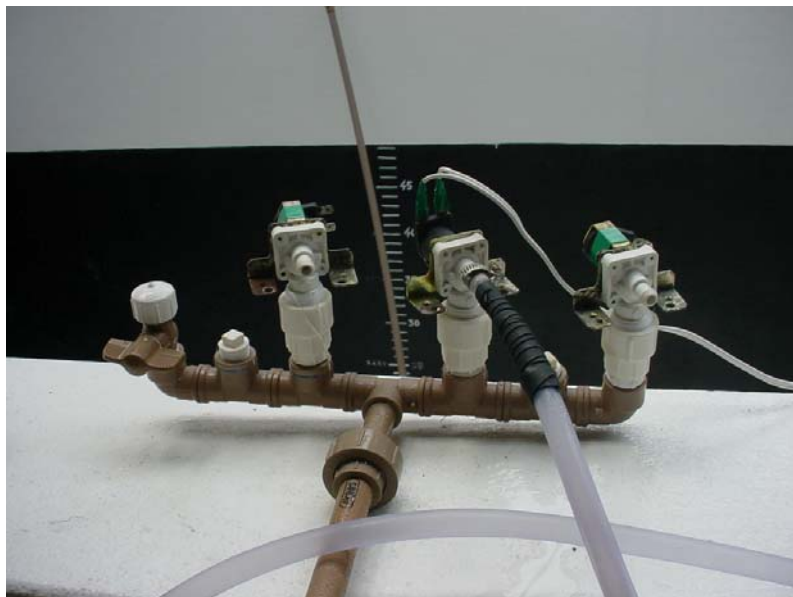
Figura 15: Solenóides para o “abre – fecha” na circulação de água
