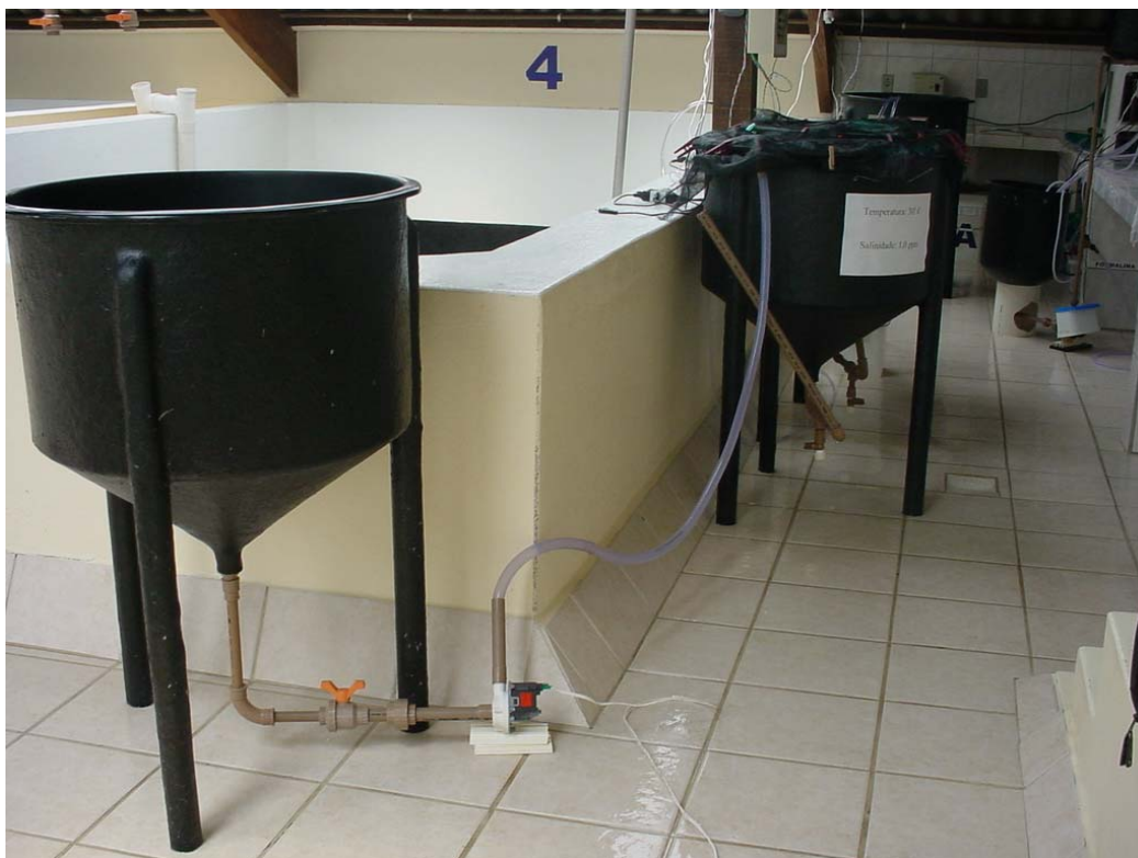
Figura 8: Sistema para ajuste da salinidade
