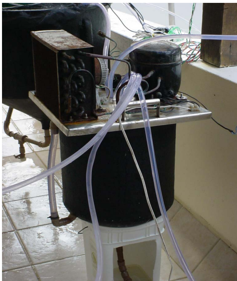
Figura 6: Sistema para resfriar água nos testes a 20 e 25°C.
