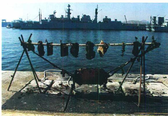
Figura 11 - Estrutura utilizada na Baía de Guanabara, para os testes com tinta anticrustante.
