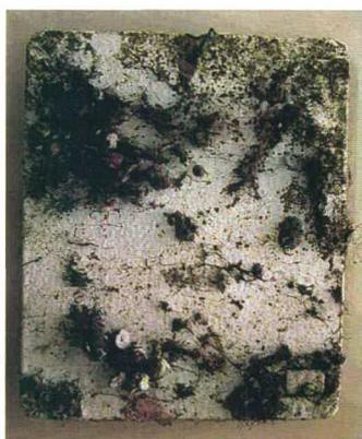
Figura 10 - Placa utilizada nos testes com tinta anticrustante.
