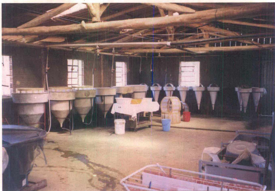
FIGURA 03 – Laboratório, no fundo incubadoras tipo funil, com volumes de 60l e 200l
