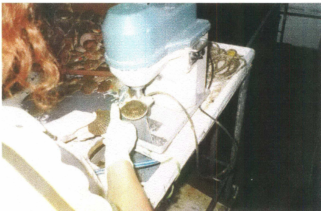
Fig. 17. Perfuração dos moluscos para confecção de cordas de loop cord .
