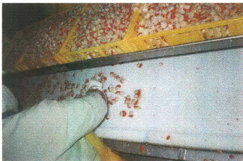
Fig. 34. Emparillado – ordenamento sobre a esteira do túnel de congelamento contínuo.
