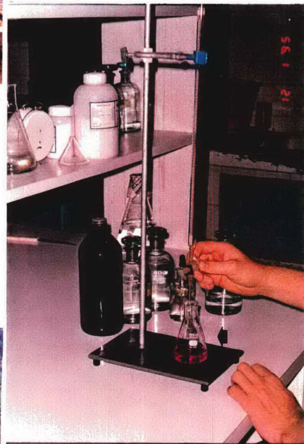
c - Titulador e coloração da solução de ameixa no ponto de viragem (conforme a seta)
