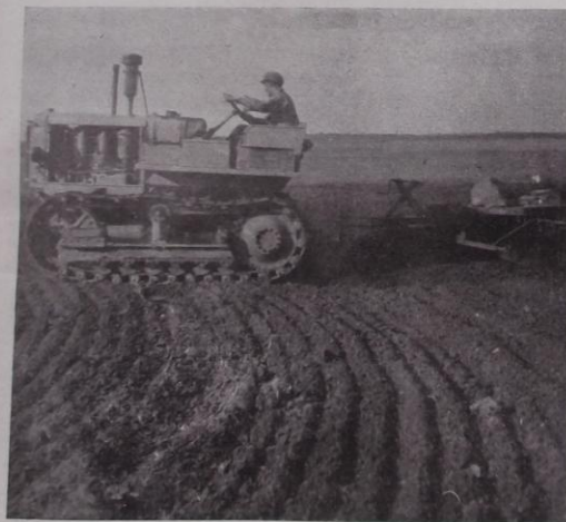
Uma experiência decisiva para a economia do Paraná é a da recuperação fulminante das terras do 3.º Planalto, lavradas para o plantio de trigo. A colônia de Entre Rios alcançou a mecanização total do trabalho agrícola, vendo-se acima um aspecto do preparo do solo, usando-se eiras concêntricas ou curvas de nível para evitar a erosão.
