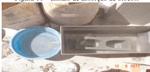
Figura 11 – Ensaio de absorção de blocos.
