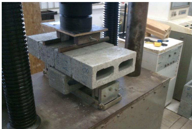
Figura 15 – Carregamento através de uma prensa hidráulica
