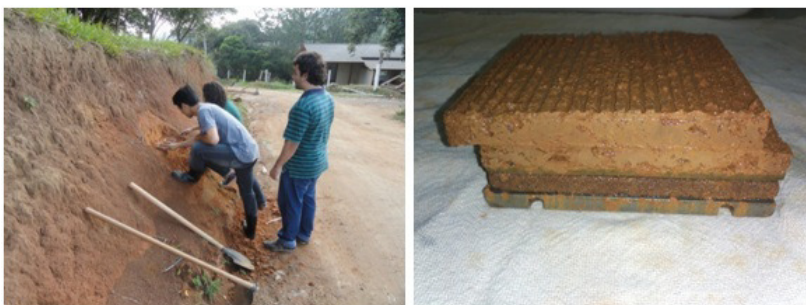
Figura 33 - Exemplo de amostragem e corpo de prova rompido - Ponto 04
