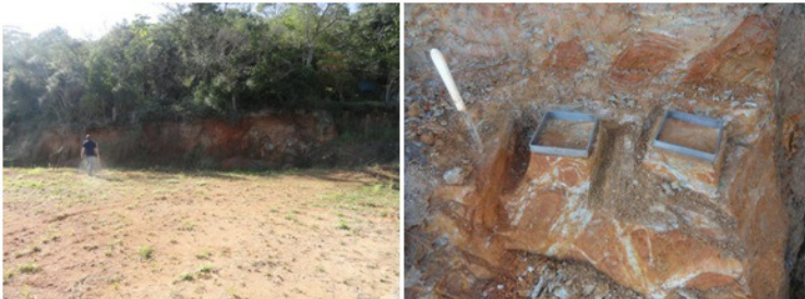
Figura 35 - Exemplo de amostragem e corpo de prova rompido - Ponto 06
