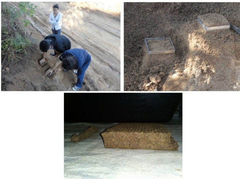
Figura 32 - Exemplo de amostragem e corpo de prova rompido - Ponto 01
