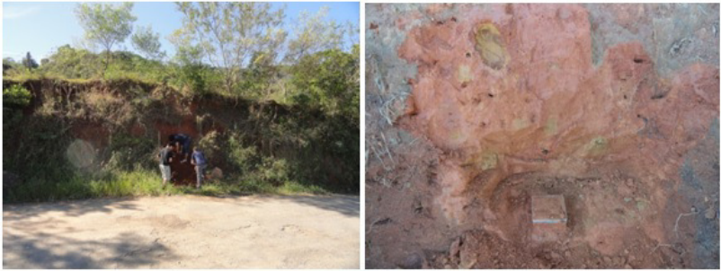
Figura 34 - Exemplo de amostragem e corpo de prova rompido - Ponto 02
