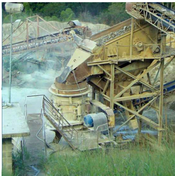
Figura 2 - Britador tipo cone empregado como britador secundário em uma pedreira na Grande Florianópolis.
