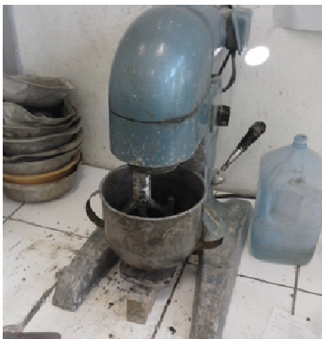
Figura 6 - Misturador mecânico empregado no preparo das argamassas.
