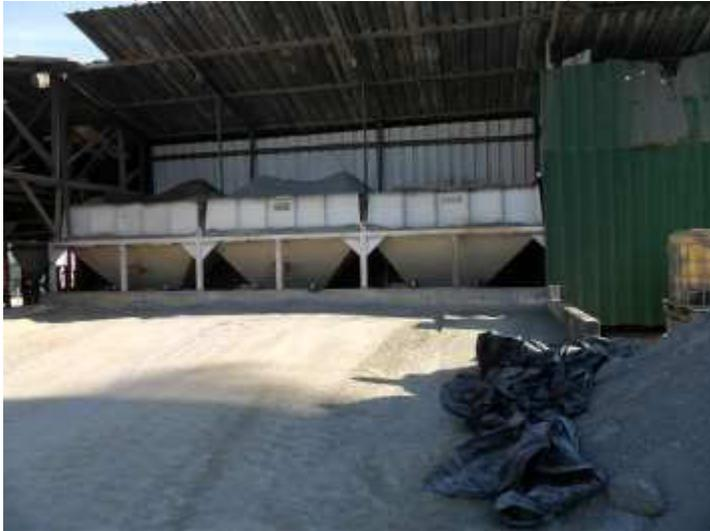
Na Figura 10, é ilustrado o misturador utilizado para as duas máquinas da “Empresa B” que, apesar de não possuir um volume elevado, é capaz de garantir material o suficiente para uma produção superior a quatorze mil blocos diários.
