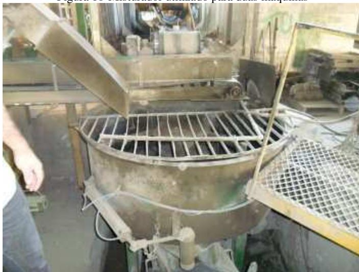
Ainda na “Empresa B”, é utilizada a máquina do fabricante Pirâmide (Figura 11), com painel automático capaz de substituir o operador da máquina, consumindo assim um funcionário a menos para o seu funcionamento. Percebe-se também uma pequena escova rebarbadora na saída da máquina, responsável por rebarbar os blocos e melhorar a qualidade final do acabamento.
