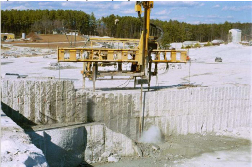
Figura 5.1 – Tecnologia de jato d’água aplicada ao corte de rochas
