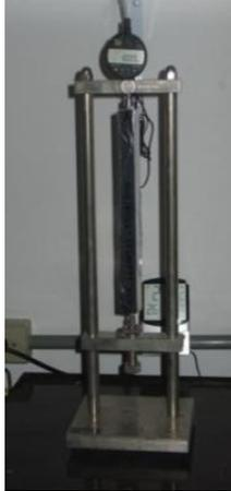
**Figura 7 – Armazenamento de prismas para determinação da retração.**
