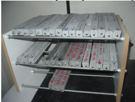
Este ensaio trata-se de corpos de prova de dimensão 2,5 x 2,5 x 28,5 cm, com um pino metálico padrão em cada uma das extremidades, axialmente centrados. A distância interna entre os pinos é chamada distância livre, e deve ser tomada antes da moldagem dos prismas.
