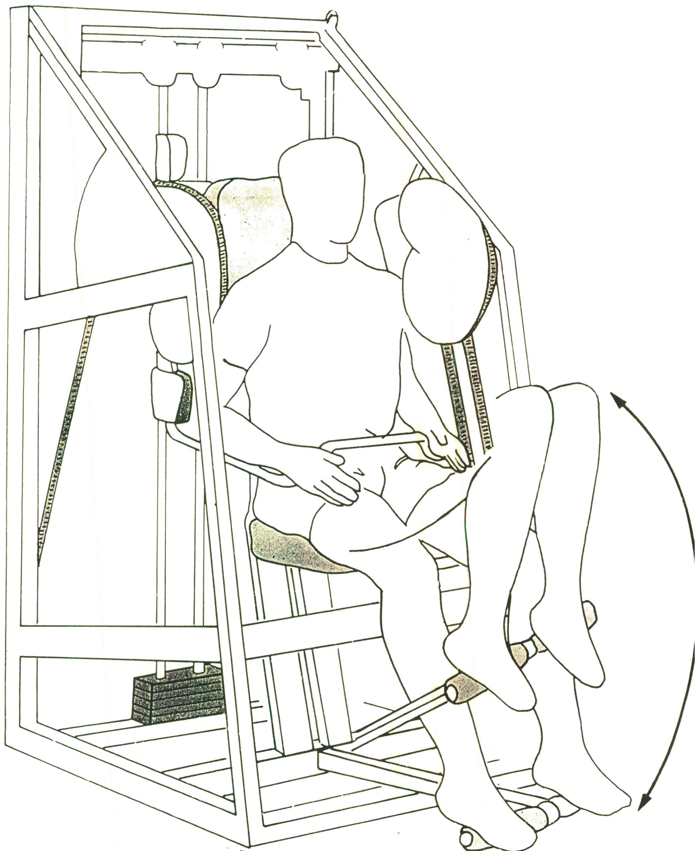
Fig. 4.8 – Módulo pullover da nautilus que permite, através de seus dispositivos, realizar trabalho apenas excêntrico ou apenas concêntrico. A aluno com o auxílio de membros inferiores, trouxe o apoio das mãos até a altura do quadril, para então realizar somente o trabalho excêntrico (neati-
