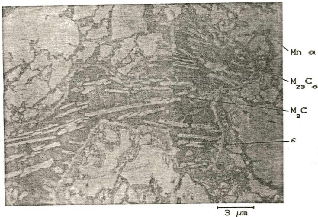
Figura 6.4 - Efeito do tempo de sinterização sobre o grau de homogeneização de liga Fe - 5% Mn (1160°C / vácuo).
