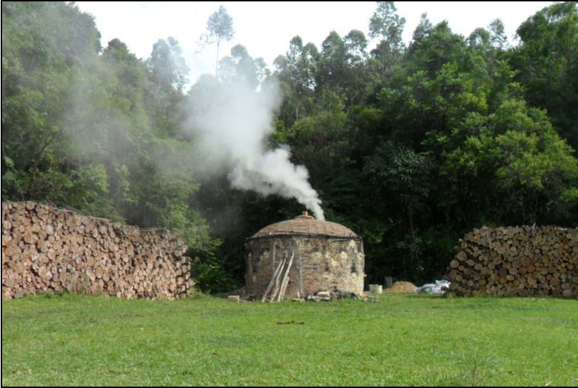
Figura 4 – Forno ativo para produção de carvão
