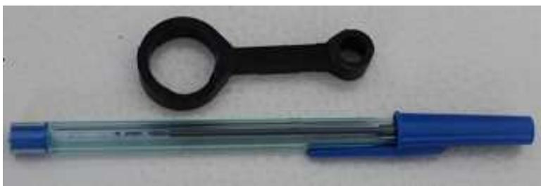
Figura 30 - Foto da biela original comparada ao tamanho de uma caneta.
