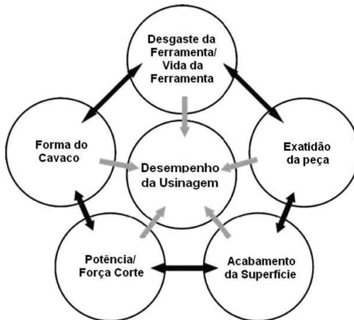
Figura 16 - Representação dos fatores que influenciam o desempenho da usinagem no torneamento.
