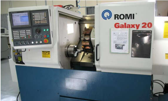
Figura 30 - Torno CNC fabricante ROMI ® , modelo Galaxy 20.
