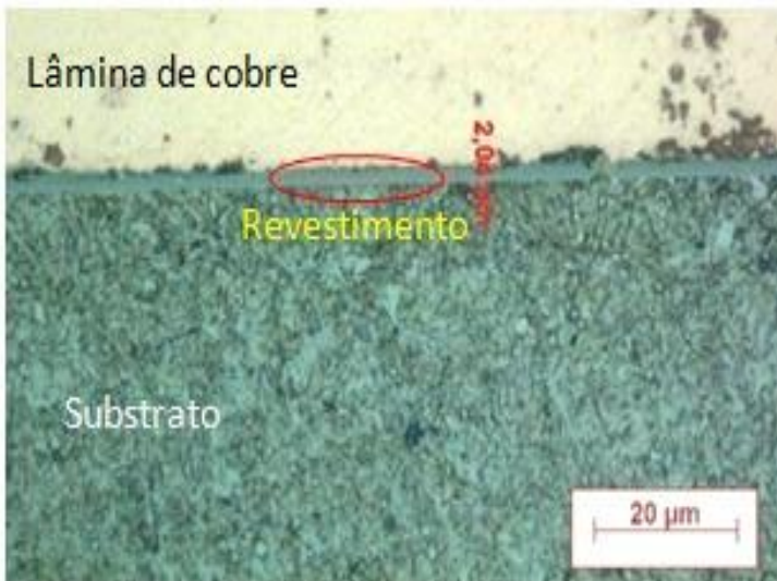
Figura 4-3 – Imagem da medição da espessura do revestimento – Amostra P1 Lote L1
