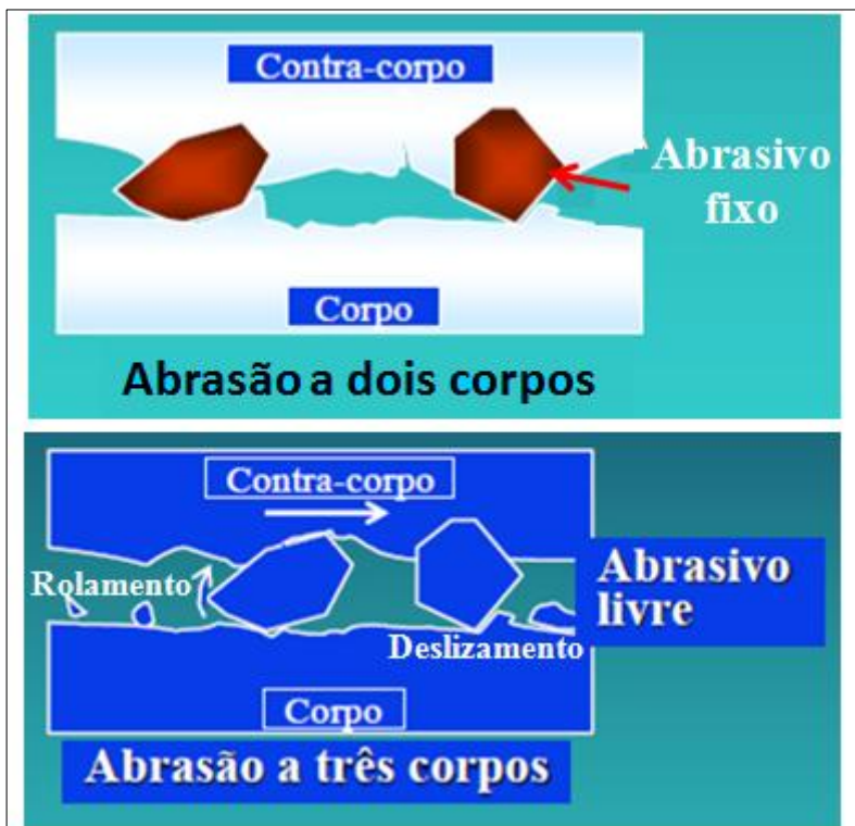
Figura 2-6 – Representação de desgaste abrasivo a 2 e 3 corpos (MELLO, 1994)
