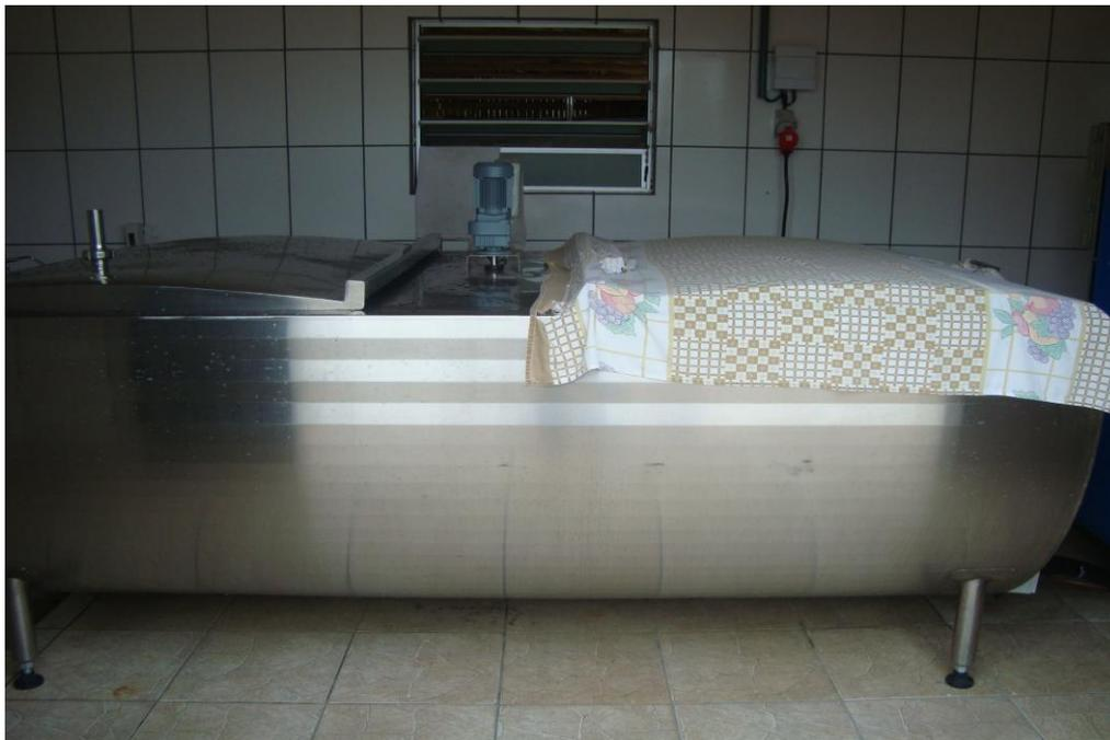
Figura 7: Resfriador a granel com capacidade para 3.000L de leite.
