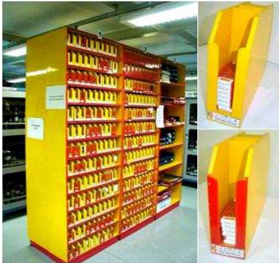
Figura 4.2 - Modelo de armário para armazenamento de ferramentas com controle Kanban .
