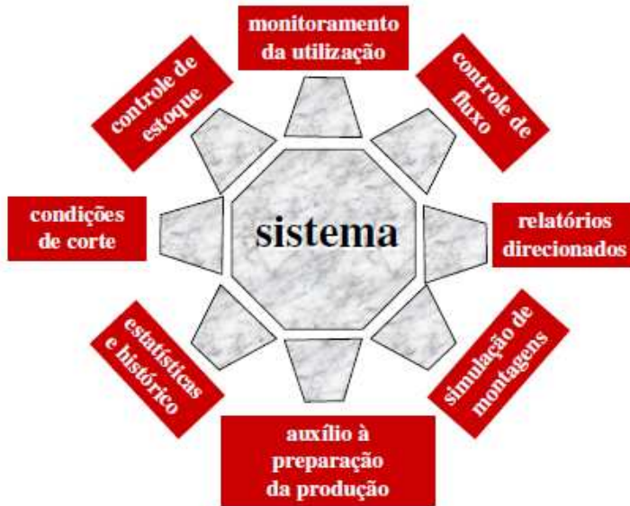
Figura 3.8 - Características de um sistema especialista de gerenciamento de ferramentas de usinagem.
