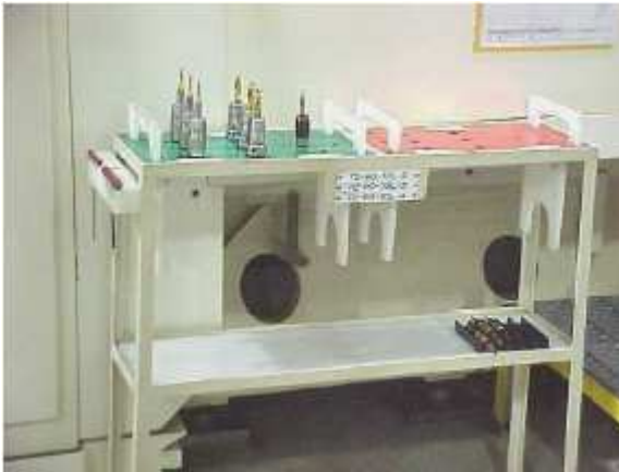
Figura 3.5 - Modelo de disponibilização de ferramentas junto à máquina-ferramenta.
