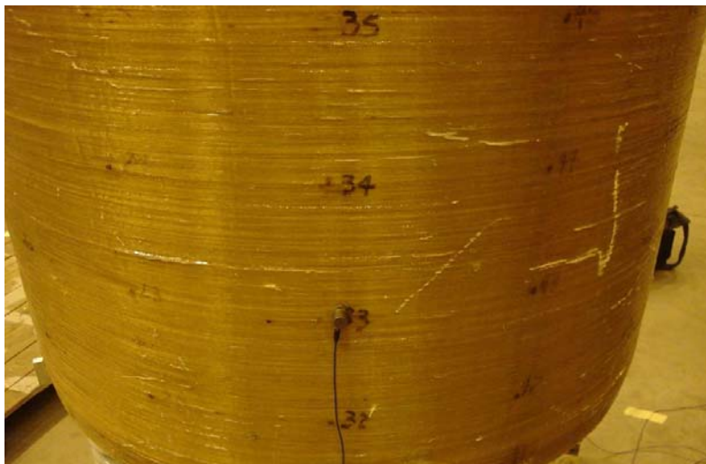
Figura 15 – Acelerômetro fixado no ponto de referência.
