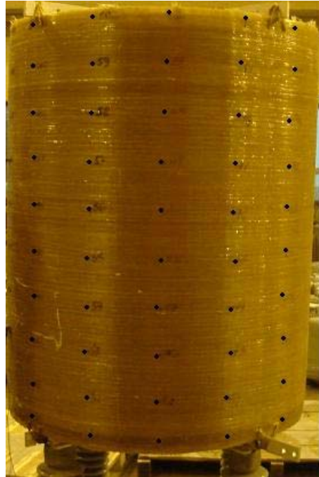
Figura 14 – Alguns pontos onde foram feitas as medições de aceleração.
