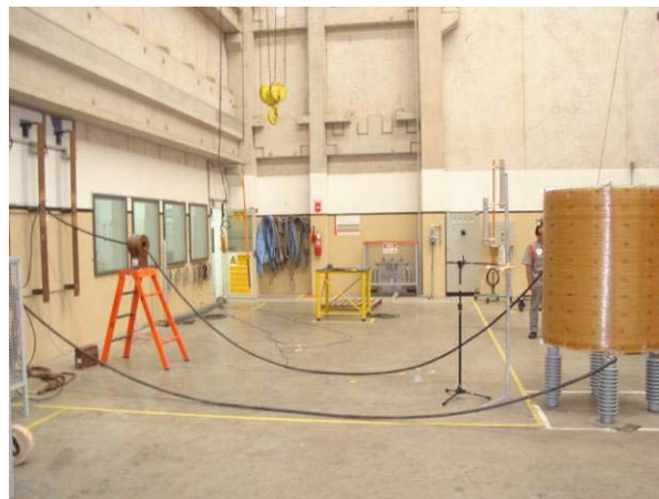
Figura 21 – Posicionamento do reator e microfone para medição do nível de pressão sonora.
