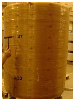
Figura 6 – FRF do ponto 37(força) em relação ao ponto 33(aceleração).
