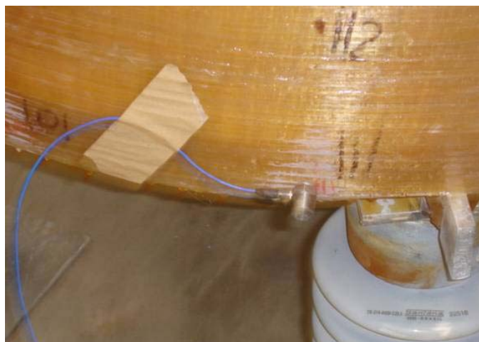
Figura 16 – Acelerômetro responsável pela aquisição dos sinais em todos os pontos, em detalhe ponto 111.
