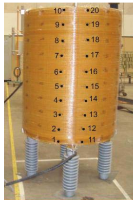
Figura 5 – Vista dos pontos utilizados para obter as FRF's da estrutura.
