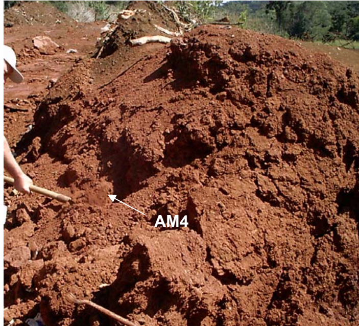
Figura 4.6 – Coleta do solo
