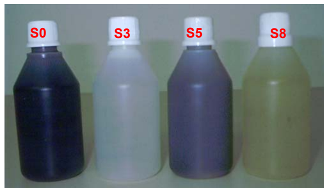
Figura 8.12 - Amostras que percolaram o solo de Timbó
