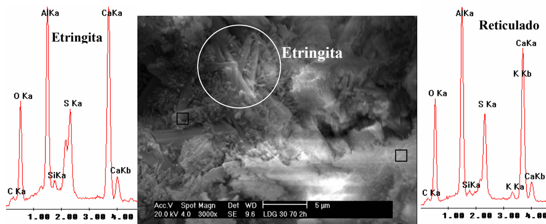
Figura 153: Micrografia da pasta CSA3070' – 2 hs de hidratação – 3000 vezes - MEV 2
