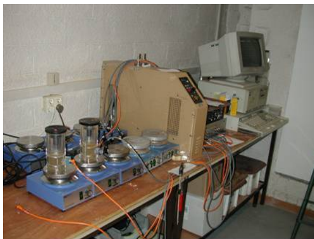
Figura 57: Aparelho de medição da condutividade do INSA/Lyon
