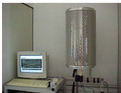
Figura 39: Equipamento de ATD do laboratório ValoRes: forno e aquisição de dados
