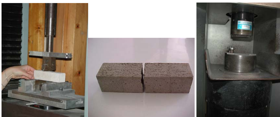
Figura 43: Determinação da resistência: método do cubo equivalente – Prensa do INSA-Lyon
