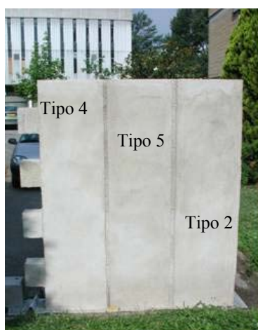
Figura 190: Revestimentos 2, 4 e 5 aplicados sobre os blocos, obtidos com o cimento BIA - F
