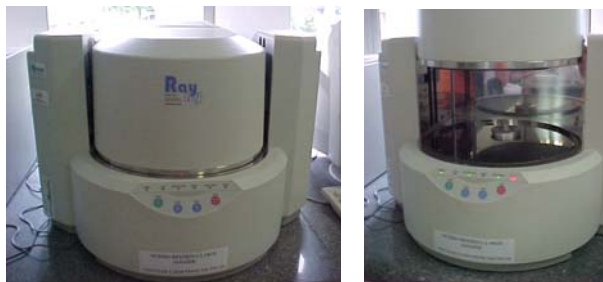
Figura 52: Aparelho EDX do laboratório ValoRes empregado nas análises químicas
