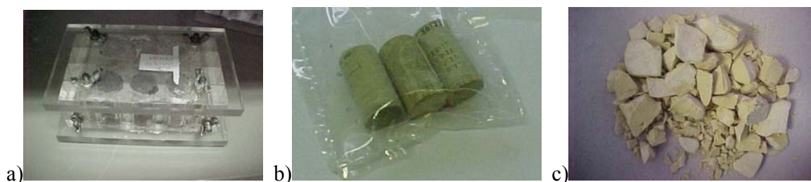
Figura 51: Moldes cilíndricos (a) e amostras submetidas ao ensaio de solubilização (b) e lixiviação (c)
