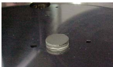
Figura 53: Pastilha prensada da matriz sólida (MS 3070) aos 90 dias de hidratação
