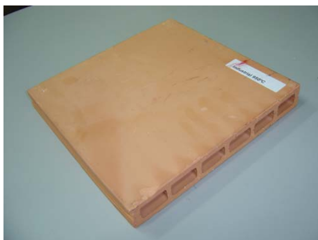
Figura 4.28 – Fotografia da placa cerâmica processada industrialmente da formulação 5
