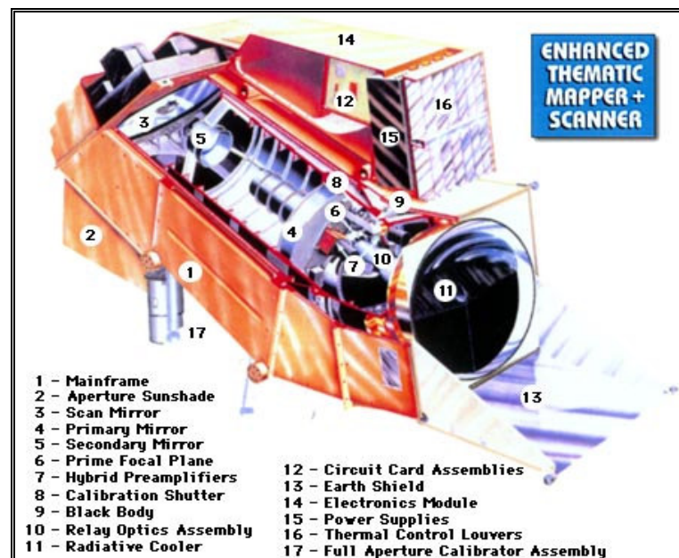
Figura 17 – Sensor ETM + do satélite Landsat-7.
